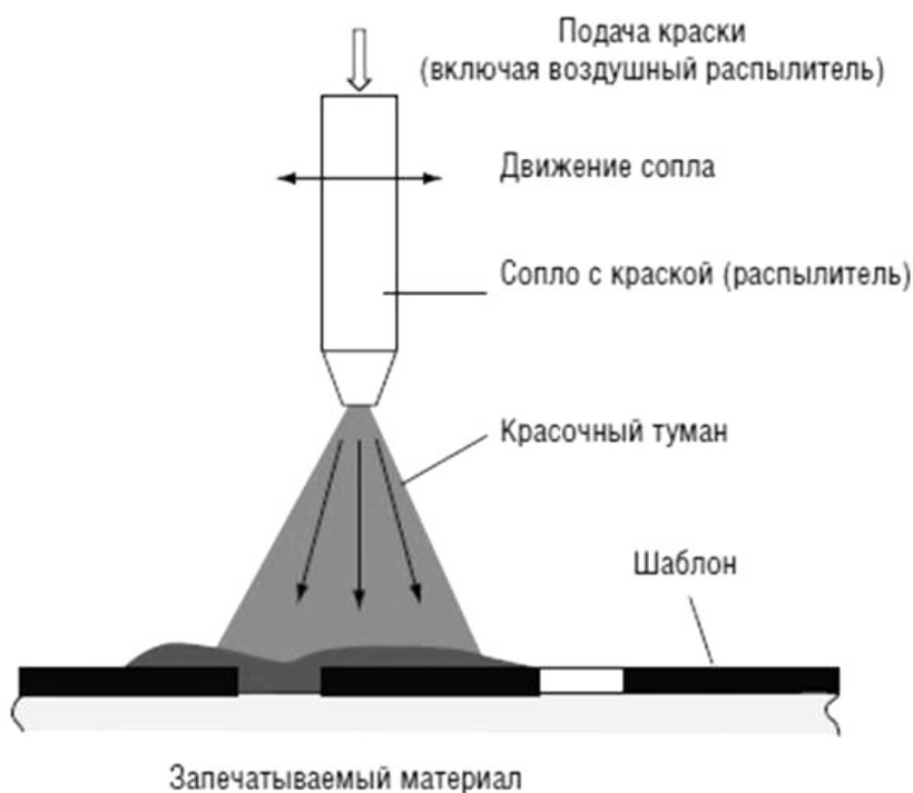
Рисунок 1- Принцип трафаретной печати.
